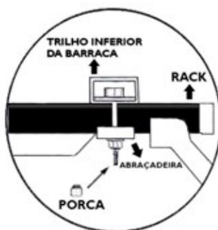
**02.02:** Deslize a barraca sobre o suporte até uma posição central. Levante um canto da barraca de cada vez e deslize as abraçadeiras macho por dentro do trilho inferior da barraca.
